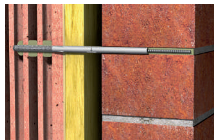
Detal: renowacja ścian osłonowych
